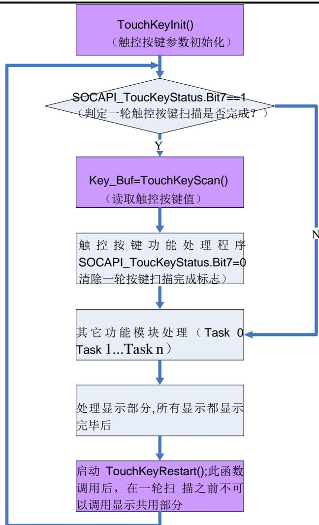
用户程序调用接口函数控制流程
