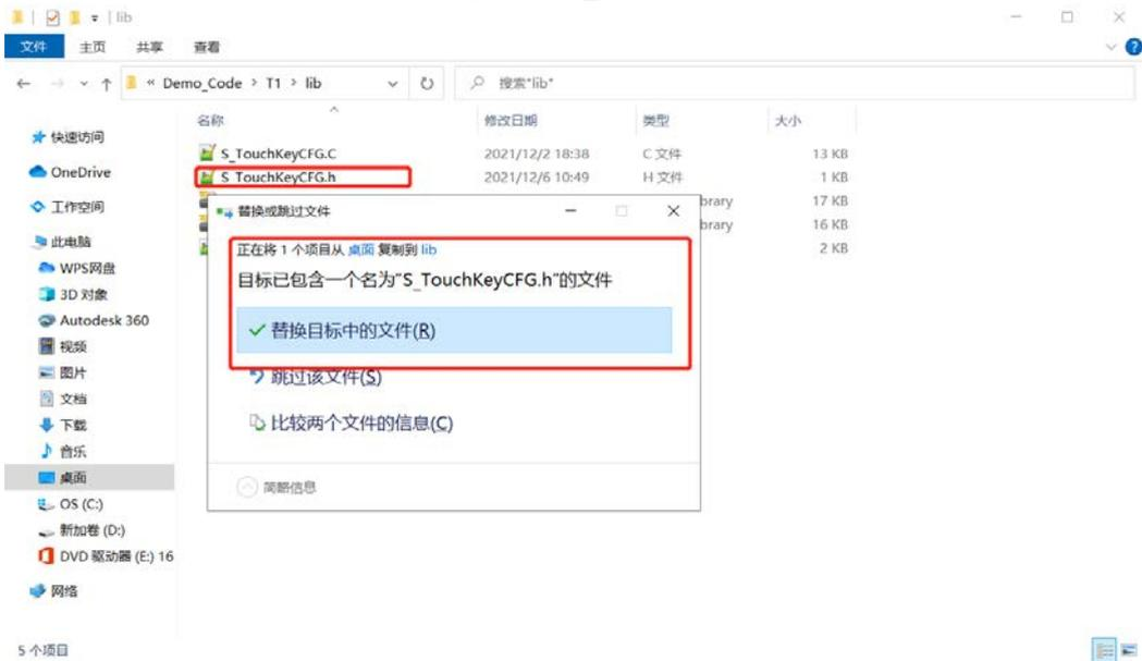
到此，完整的赛元触控高灵敏软件库已添加至项目工程内。
