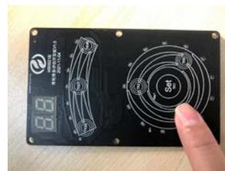
滑轮滑条调试阶段将手垂直紧贴于锯齿中心感应面上方，如左图所示白色区域
