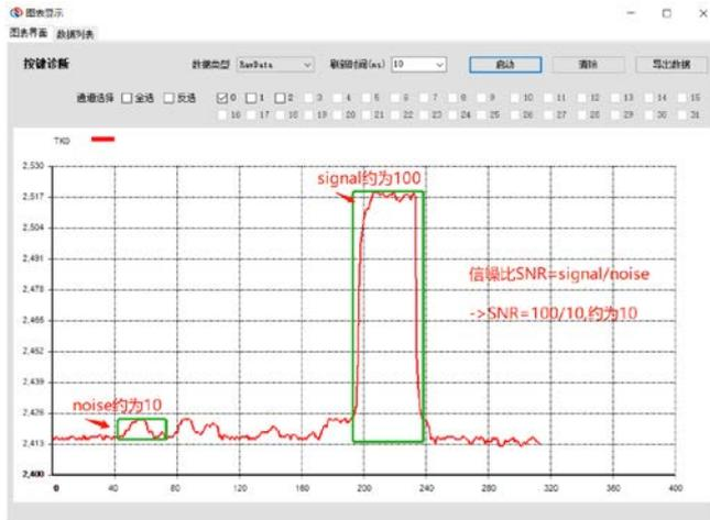
SNR 计算方式：动态调试观测中
