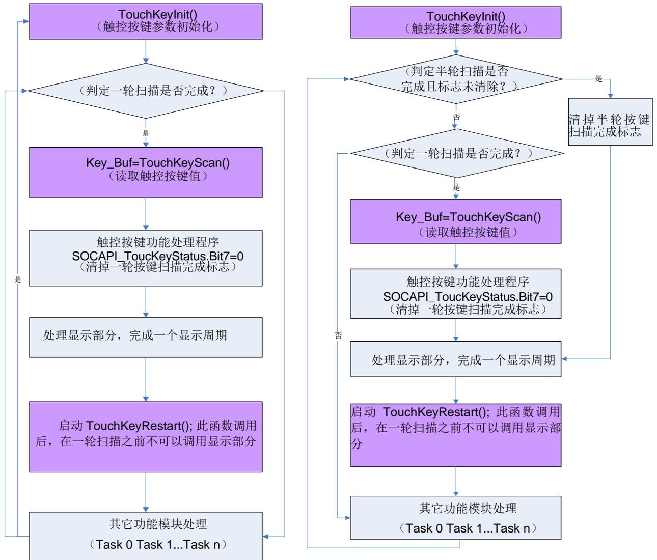
用户程序调用接口函数控制流程（按键个数8个以下）
