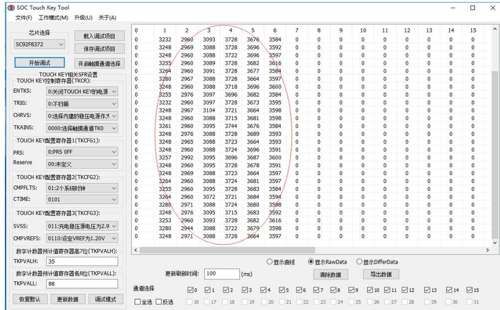
图中所圈部分即是选中的 TK1~TK7 的 7 个通道的 TKCNT 值，每一列代表一个通道，没有选中的通道 TKCNT 值为 0。如果出现特殊情况，有可能是数据太大，超出了 TKCNT 的范围，请检查 Cadj 的电容是否接错，或者减小此电容。
